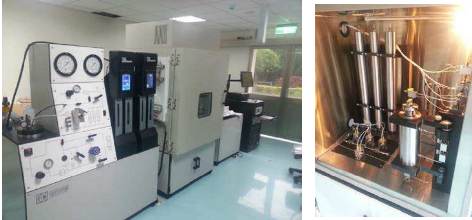
圖五、DCI 岩心沖排試驗系統之實際組裝圖。
